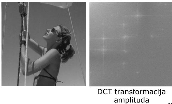
DCT transformacija amplituda
