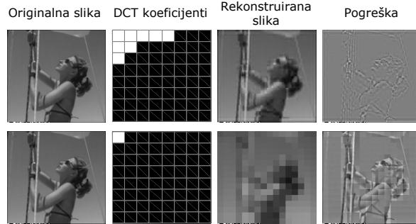
Originalna slika DCT koeficijenti Rekonstruirana slika Pogreška
