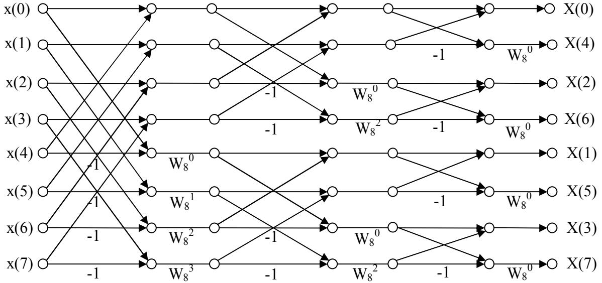
Izračun DFT-a po ovom algoritmu za niz  $x(n)=\{1,2,3,4,5,6,7,8\}$  po međutočkama daje:
