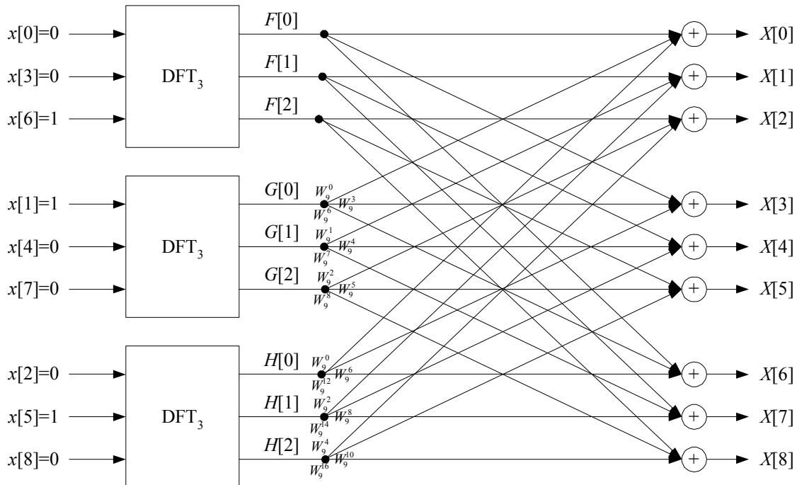
Transformacije na izlazima iz svakog bloka za računanje DFT-a, te konačna transformacija:
