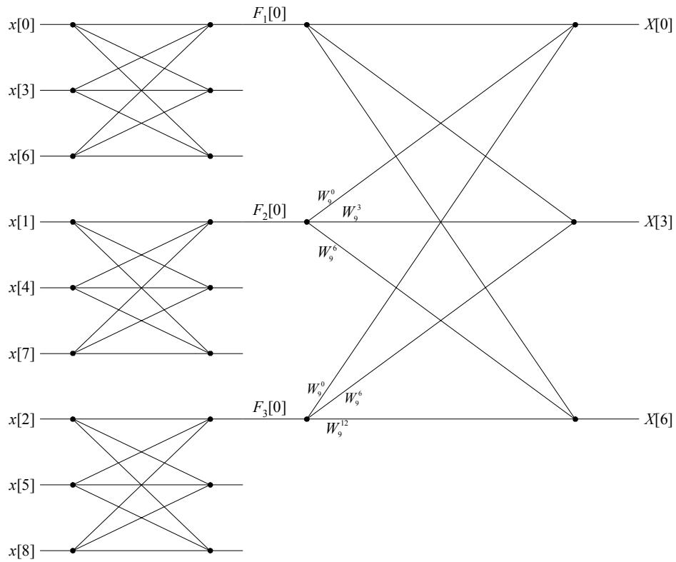
Analogno spajamo osnovne strukture na izlaze  $F_i[1]$  i  $F_i[2]$  struktura prvog stupnja, te je konačni graf toka signala (dio koeficijenata s kojima se množe signali je ispušten zbog preglednosti):
