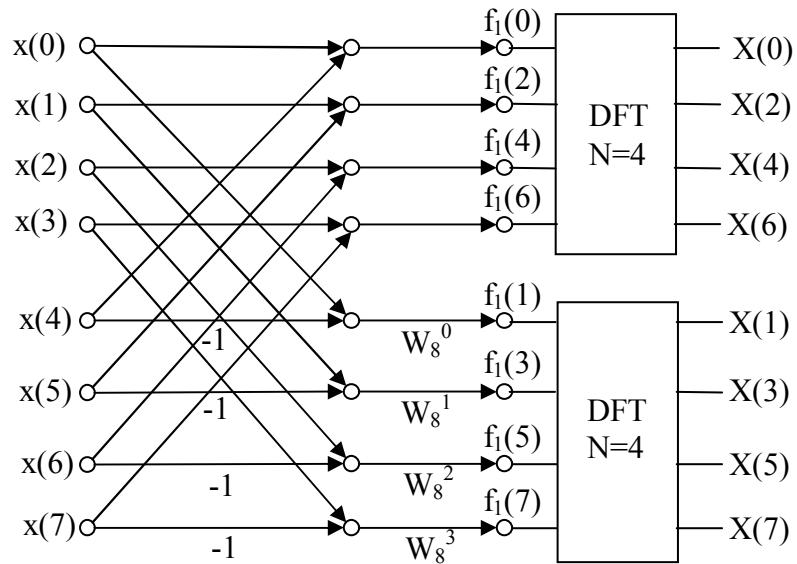
Blok DFT, N=4 zamjenjuje se analogno dalje sa sljedećim segmentom grafa toka signala:
