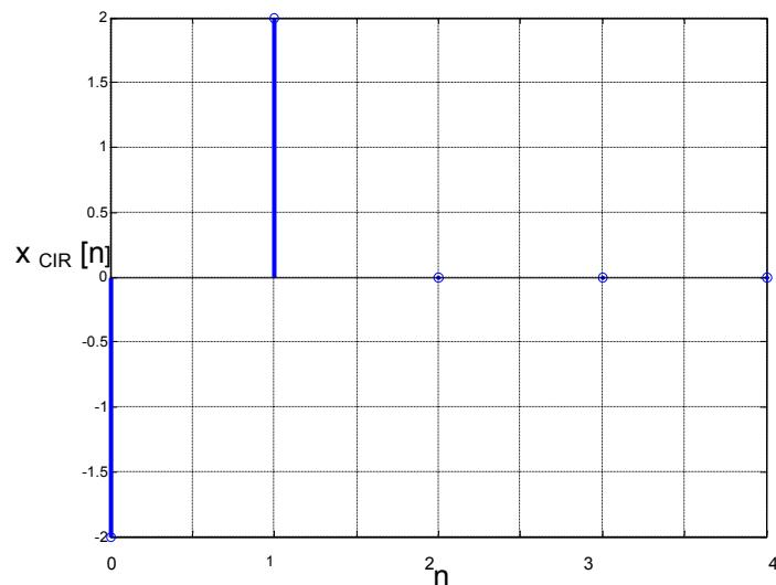
Periodička konvolucija  $x_{PER}[n]$  signala dobivenih periodičkim proširenjem signala  $x_1[n]$  i  $x_2[n]$  dobiva se periodičkim ponavljanjem cirkularne konvolucije. Periodička konvolucija prikazana je na sljedećoj slici:
